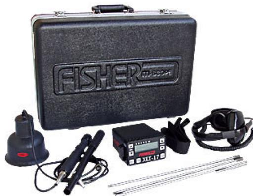
Este ruído tem sua frequência compreendida entre 100Hz e 2.800Hz no máximo. As frequências mais baixas em ruído de vazamento são caracterizadas por um som grave e os de alta intensidade por um som agudo. Um dos fatores que define esta frequência do ruído do vazamento é justamente a pressão em que a rede está trabalhando, diâmetro do tubo, material e tamanho da fenda do tubo.
